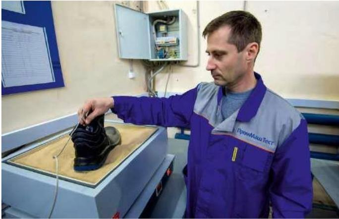
**Gerät zur Bestimmung der wärmedämmenden Eigenschaften von** Schuhen, wenn sie verschiedenen negativen Temperaturen ausgesetzt sind
